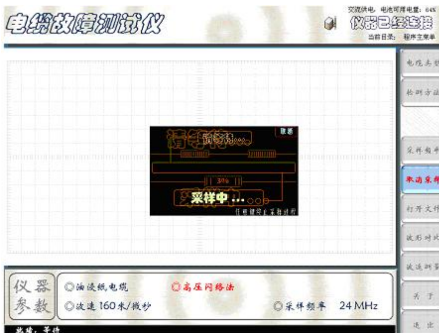
图十九 冲击高压闪络法预置界面示意图
