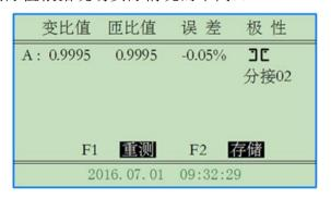
此时,可以按 [T] "重测"、 [F2] "存储", [打印] 键打印当前显示的数据。
