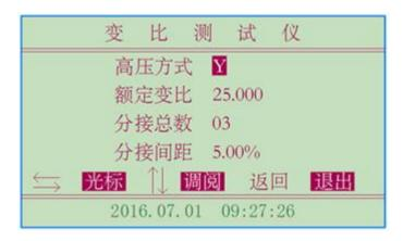
按下**向左**或**向右**键,光标可以在各个参数之间循环移动,可将光标移动到需要改变的参数上;
