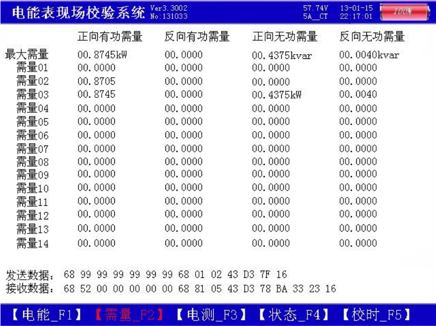
图十三、测试_485 需量 按 F3 可调三相电压、电流、有功功率、无功功率、功因数。
