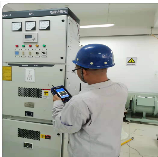
开关柜非接触超声检测
